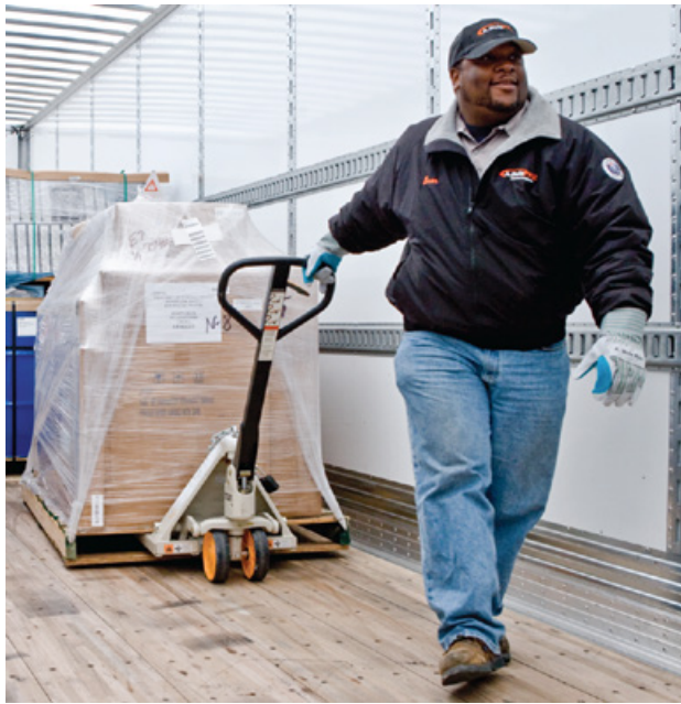
El retractilado de un envío en el pallet ayuda a reducir los daños.
