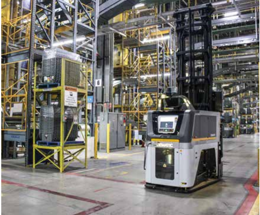
Los vehículos autoguiados (AGV) siguen marcadores o el cableado en el suelo del almacén y usan láseres, activación por voz e imanes para la navegación.
