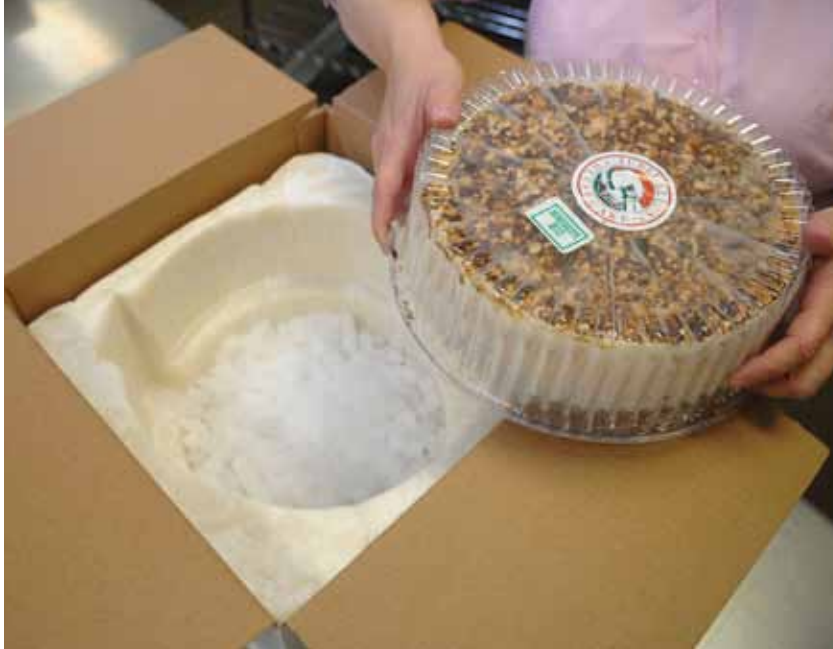
La solución de embalaje que Jubilations Cheesecakes desarrolló incorpora inserciones de espuma de poliuretano, hielo seco y cartón corrugado para asegurar que la llegada de sus productos sea un motivo de celebración.
