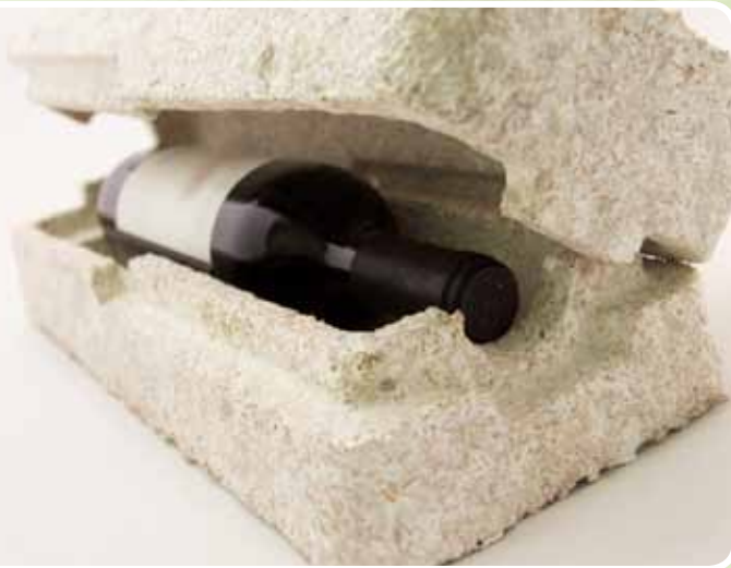
El material de acolchado EcoCradle de Ecovative Design se cultiva en un molde por un periodo de cinco a siete días con hongos y productos derivados de la agricultura como tallos de plantas o cáscaras de semillas.
