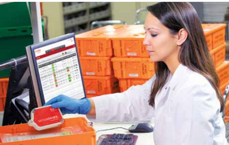
Para proteger los envíos farmacéuticos sensibles a la temperatura, FedEx utiliza herramientas como las mantas térmicas (arriba) y los dispositivos SenseAware, que contienen sensores para monitorear la temperatura, la exposición a la luz, la humedad y otros factores que podrían afectar a los medicamentos en tránsito.
