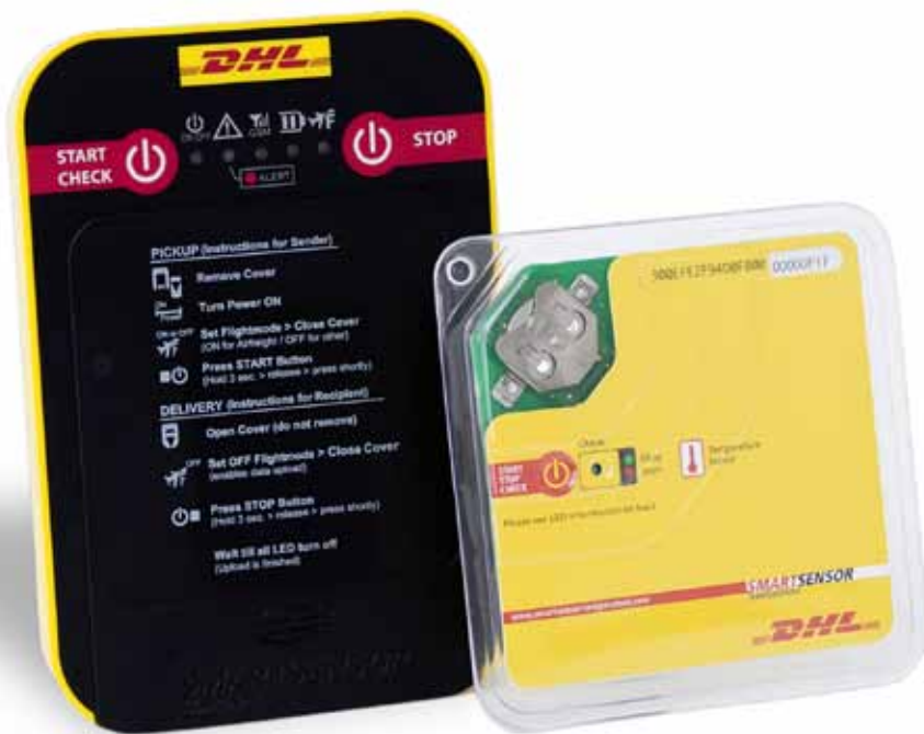
Los capturadores de datos de Sensor Smart de DHL registran la temperatura y la humedad de los envíos en tiempo real para detectar las fluctuaciones y ayudar a evitar el desperdicio.
