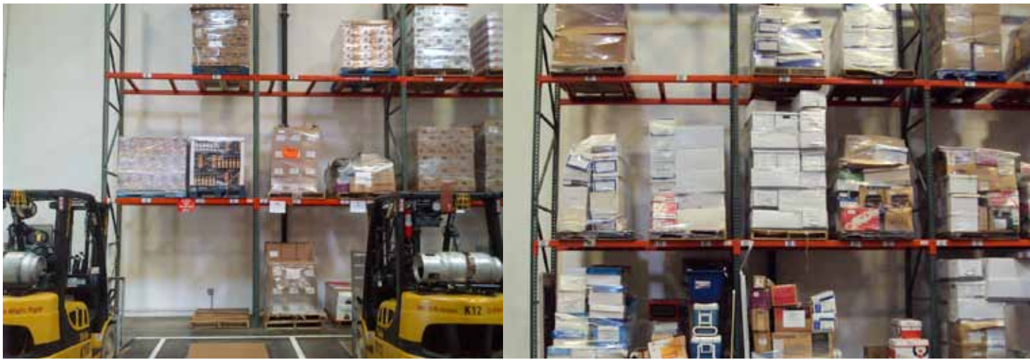
Para una compañía, un sistema de estantería desorganizado (izquierda) desperdicia tiempo y esfuerzo de los trabajadores. Sin embargo, después de que APL Logistics implementó la técnica 5S esbelta los trabajadores pueden localizar el equipo y los suministros con facilidad (derecha).
