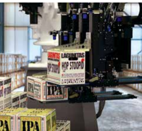
Los robots de Honeywell usan tecnologías de visión artificial y de aprendizaje automático para localizar y manipular artículos individuales.
