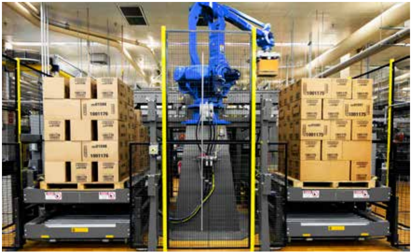
Honeywell Intelligrated ofrece bots para muchas aplicaciones, entre ellas el paletizado y despaletizado, y el apilamiento y embalaje de pallets en un solo proceso.
