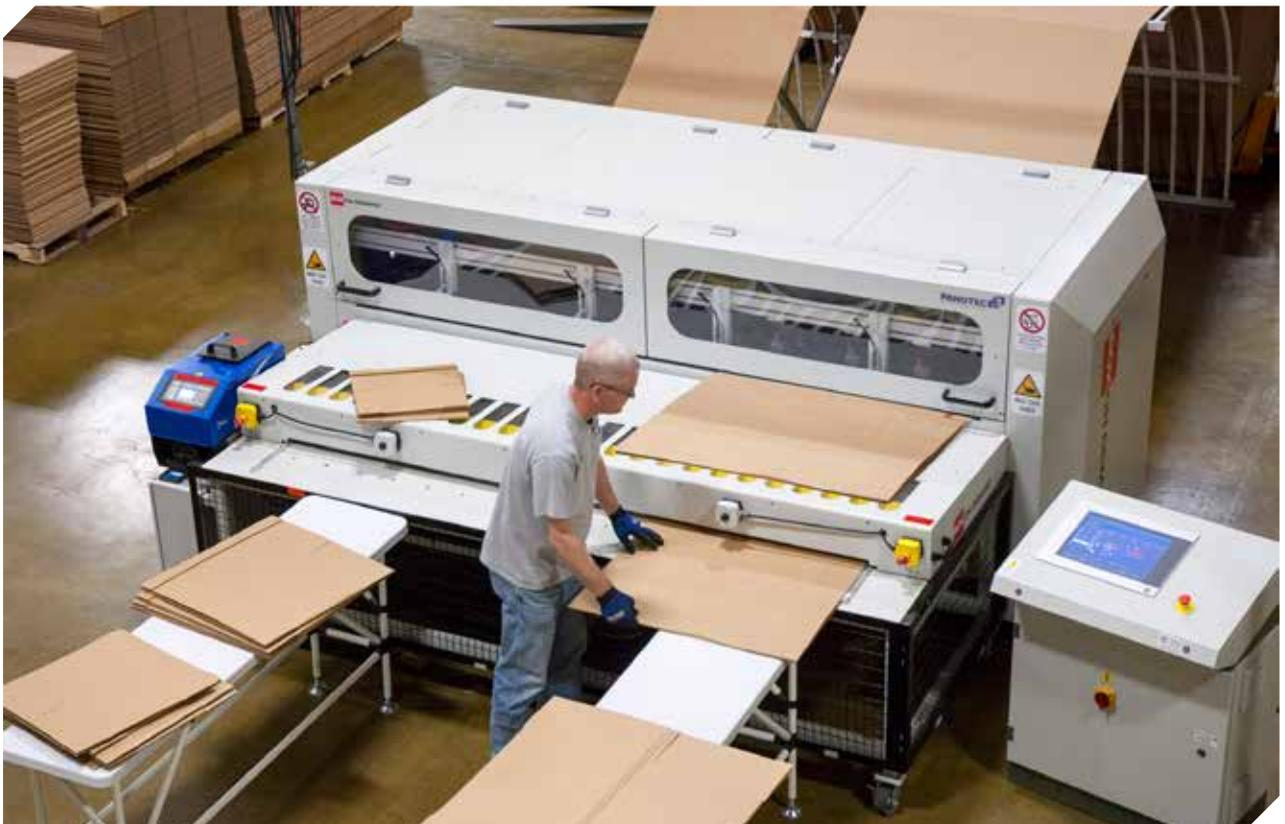
Soluciones como el sistema Box On Demand producen de forma rápida y rentable empaques personalizados de papel corrugado, que permiten a los transportistas mantener los mismos costos de embalaje en cualquier configuración, cantidad o diseño.
